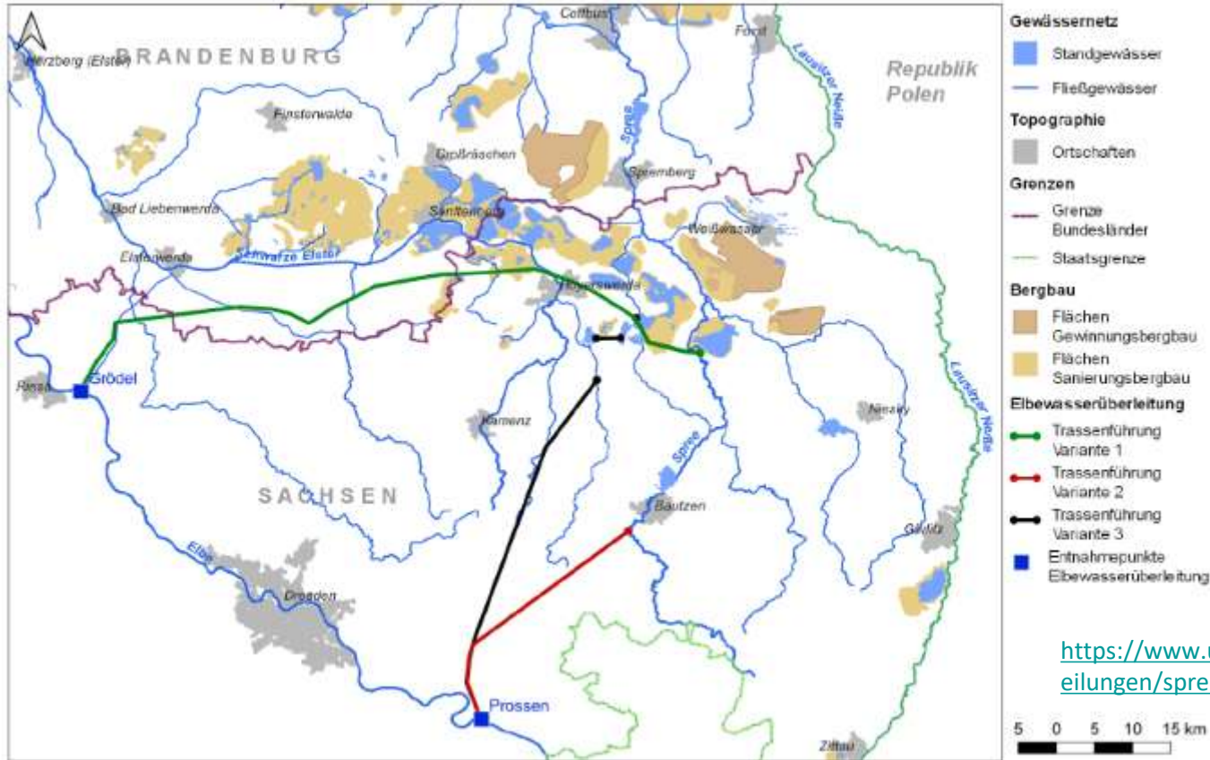
Abbildung 86: Varianten der Elbewasserüberleitung
